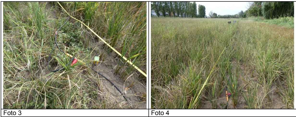
Figura 17 – Profilo 5, Roggia Ticinello. Misura in sito delle onde di taglio orizzontali Vs30 m.
