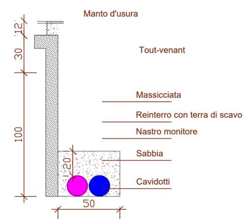
**SCHEMA POZZETTO D'ISPEZIONE**
